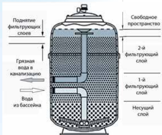
Рис. 4 Фильтр в режиме «обратной промывки»
