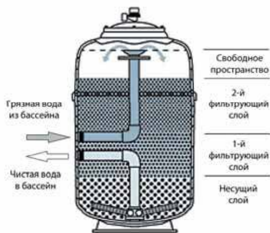
Рис.3 Фильтр в режиме фильтрации
